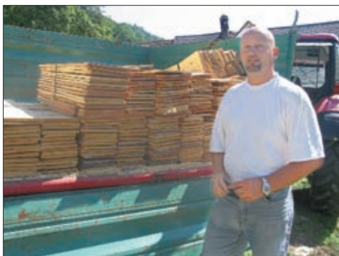
Ročno cepljenih skodel ni potrebno barvati, saj imajo že same dovolj zaščite za vlago in druge vremenske vplive.
