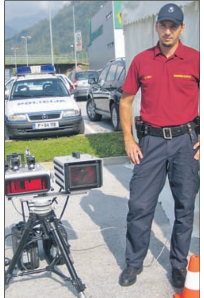
Stacionarni radar podjetja SG Biro je sodobna naprava, ki lahko pokriva celo šestpasovno cesto, meri pa v obe smeri. Ob njem občinski redar Matjaž Kučina.
