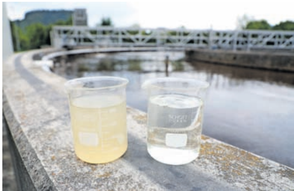
Da čistilna naprava na Bledu dobro deluje, je Anže Bizjak dokazal tudi v vzorcema vode. Na levi vzorec ob pritoku v čistilno napravo, na desni vzorec ob iztoku iz čistilne naprave. / Foto: Tina Dokl
