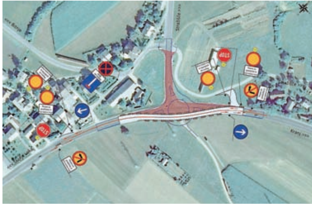
Krožišče na državni cesti Kranj–Škofja Loka, v katero se priključi tudi Škofjeloška cesta iz Stražišča, bo premera 38 metrov, na vseh priključnih krakih pa bodo zgrajeni tudi ločilni otoki.
