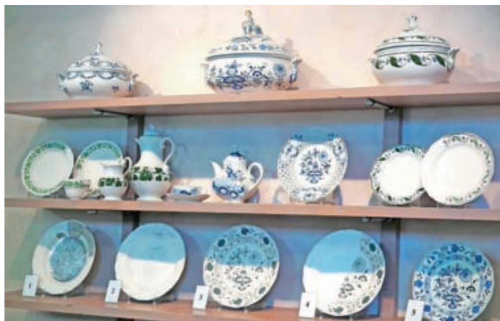
Na stenah in policah demonstrativnih delavnic so razstavljeni različni deli oziroma faze, skozi katere gre izdelek. V konkretnem primeru je na spodnji polici prikazano, kako v petih fazah nastane krožnik.
