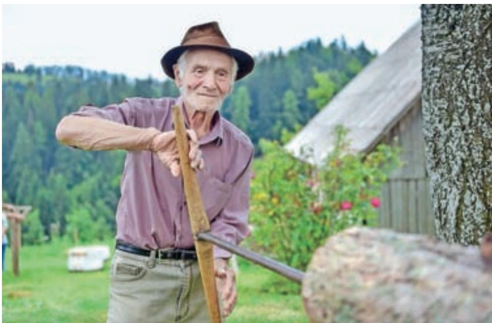
Janko Primožič uporablja dva metra in pol dolg in kakih dvesto let star sveder, s katerim je cevi vrtal že njegov ded. / Foto: Andrej Tarfila
