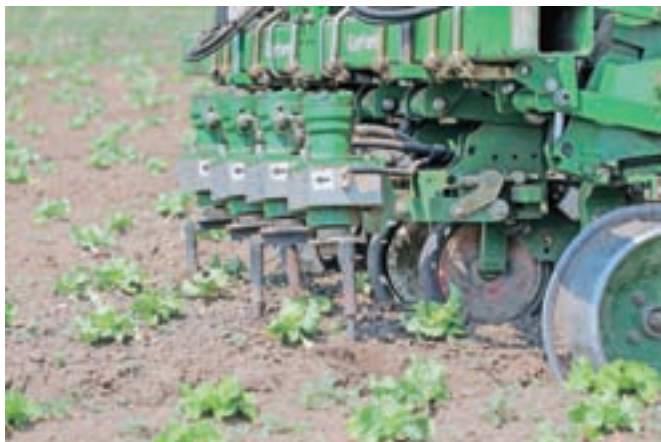
Stroj angleškega proizvajalca, kraljica Elizabeta je zanj inovatorjem podelila priznanje. Stroj uniči okrog devetdeset odstotkov plevela in ima infrardečo kamero, zato z njim lahko delajo tudi ponoči. / Foto: Tina Dokl
