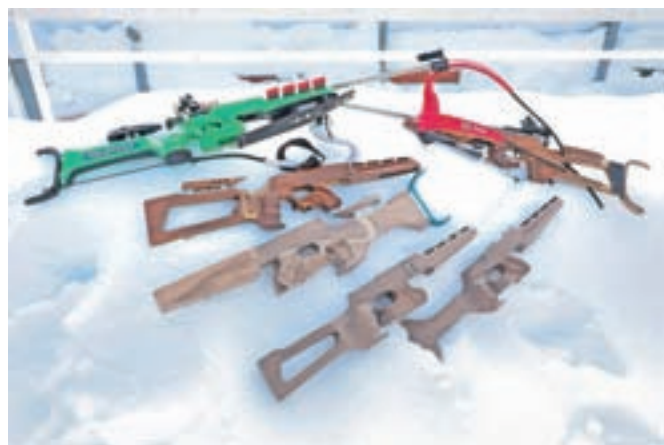
Nekaj kopit Mateja Gruma; kombinira les in karbon. Kopito tehta od osemsto do tisoč gramov, teža celotne puške pa je 3,5 kilograma (manj ne sme biti). / Foto: Tina Dokl
