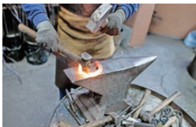
Razbeljeno železo je treba hitro obdelovati.
