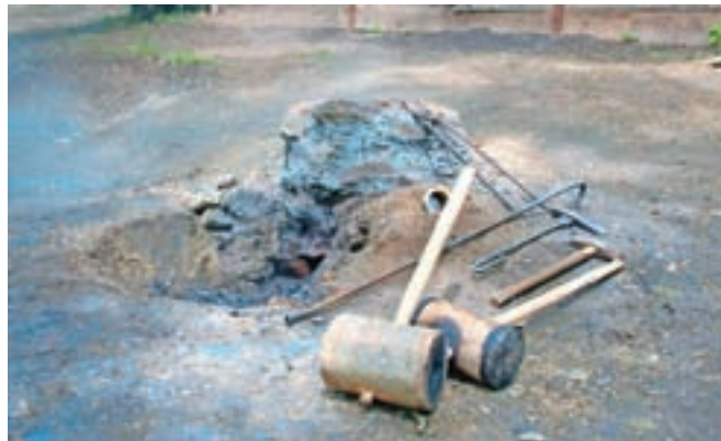
Poskusna talilna peč z vsem potrebnim orodjem
