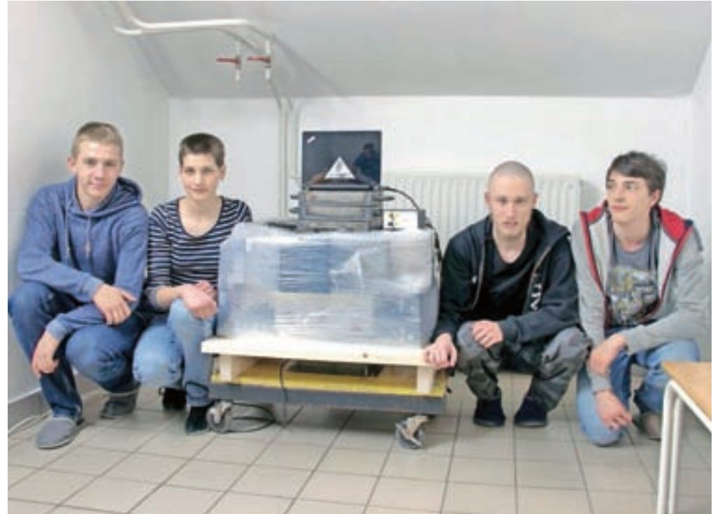
Mladi raziskovalci Gimnazije Jesenice, avtorji dveh izvrstnih raziskovalnih nalog o Černobilu, s katerima so se uvrstili na državno tekmovanje, s spektrometrom gama o ohišju iz svinca, ki uduši naravno sevanje. / Foto: Andrej Mežik
