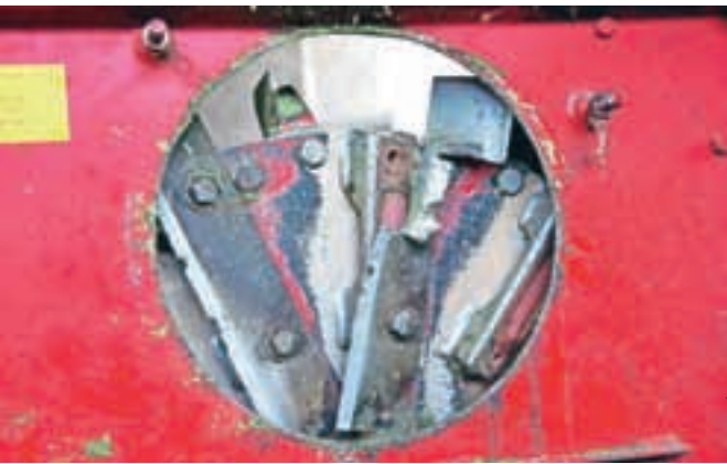
Poškodbe v kombajnu samo zato, ker se je nekdo izživljal.
