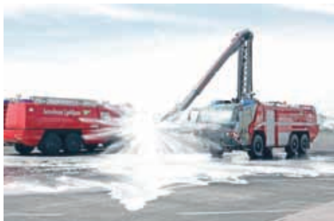
Letališko gasilsko vozilo Rosenbauer Panther je opremljeno z dvizžno teleskopsko roko in s konico za prebijanje trupa letala za gašenje notranjih požarov. / Foto: Gorazd Kavčič
