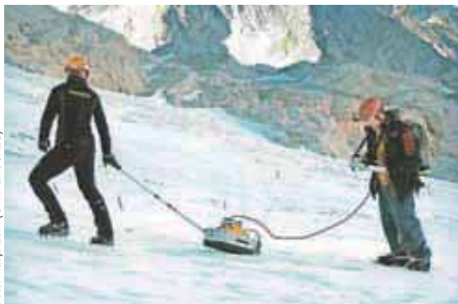
Merjenje debeline ledenika z georadarjem
