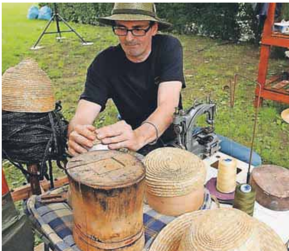
Za izdelavo enega slamnika je potrebnih okoli trideset metrov slamnatih kit in številni pripomočki, kot so likalnik za kite, šivalni stroj, različni modeli, stiskalnica
