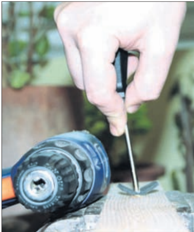
Čez glavo vijaka lahko položite gumo, ki poveča trenje izvijača na poškodovani glavi in pomaga pri odvijanju.
