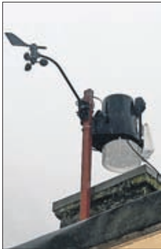
Novi vremenski postaji zbirata podatke o temperaturi, o smeri in hitrosti vetra, o spremembi pritiska, osončenosti in količini padavin. / Foto: arhiv TNP
