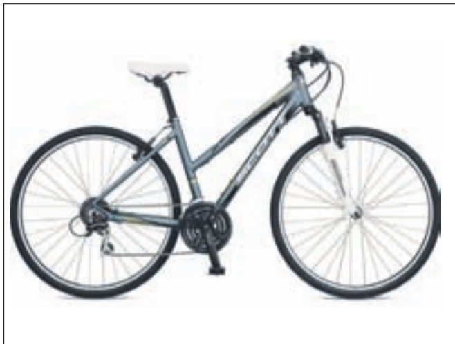
Žensko trekking kolo boste prepoznali po izrazito poševni glavni cevi okvirja.
