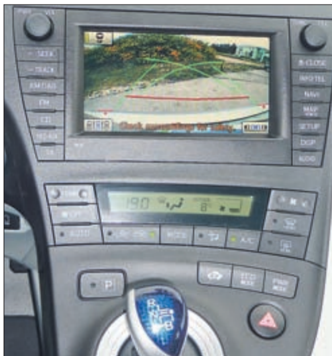
Pri vzvratni vožnji je v pomoč kamera, ki pošilja sliko na osrednji komunikacijski zaslon.
