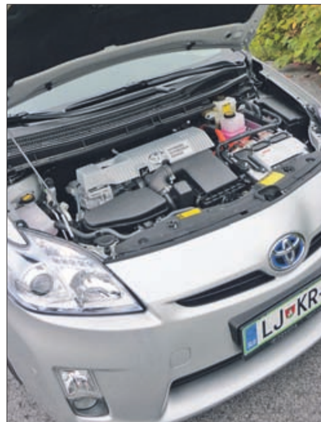
Popolnoma prilagodljiv pogon izvaja novi 1,8-litrski bencinski stroj s pomočjo dveh elektromotorjev.
