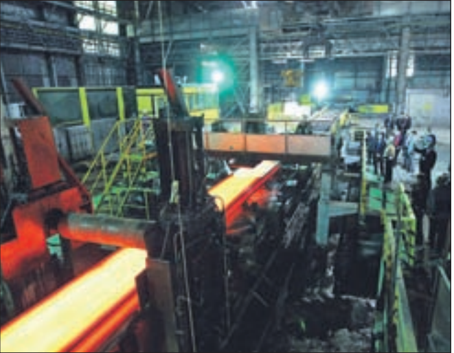
Prvi slab (jekleni ulitek) iz uradno odprtega kontiliva, poimenovanega Katarina Velika.
